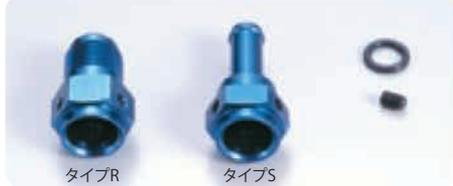
タイプR (AN6オス)はスィベルシールホースエンドの#6サイズがダイレクトに装着できます。タイプSはホース口(ホース止め部分7.9Φ)で#6サイズのホースを差し込んでメカクランプ(P39)等で止めるタイプです。
