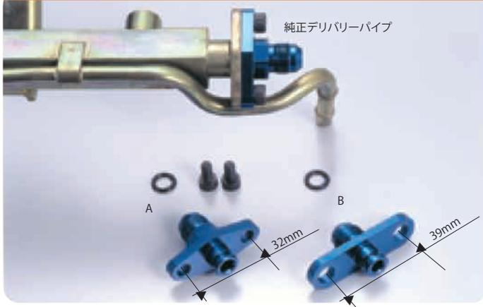
純正のフューエルプレッシャーレギュレータを取り外し、APP・グッドリッジホースエンド #6サイズの燃料ラインで取廻しをする場合に使用するアダプターです。この場合、プレッシャーレギュレータは社外品を使用してください。
