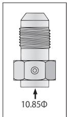
・Oリング(IP8)内径7.8mm・ゴム径1.9mm:¥315 (錆¥300)×1ヶ
