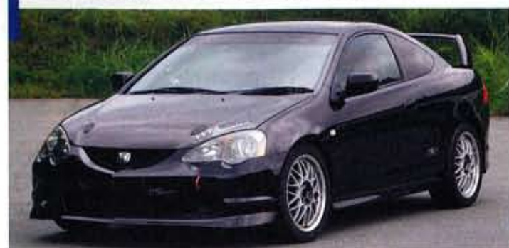
ミュルサンヌのDC5がテスト車両。これにAPPのブレーキキャリパーキットとブレーキホースをセットしている。タイヤはディレッツァZ1スターズペックでサイズは215/45-17
