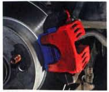
リアブレーキはパッド交換のみで使用するパッドは800℃対応のKG1115。このほかキャリパーキットにはストリート用のAP5000とワインディングにも対応するAP8000が選択できる
