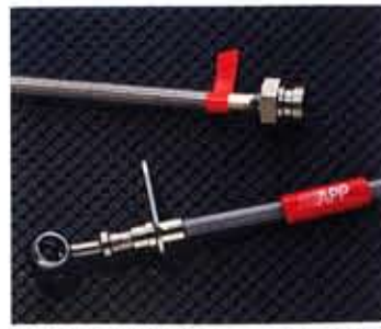
熱や膨張に強いPTFEホースがベースなのでダイレクト感が強い。その上にカーボンブラックのコーティングをすることで、泥跳ねや飛び石などからホースを保護している
