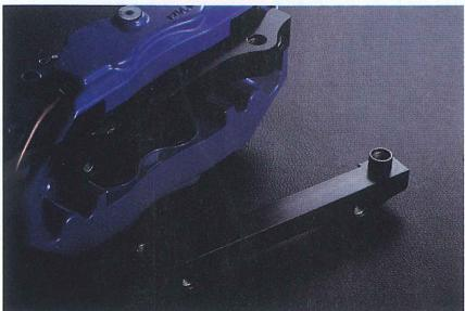
ナックルとブレーキキャリパーの間にかませる専用ブラケットはアルマイト処理がほどこされたジュラルミン製だ。強力な制動力にも耐えうる強度と、軽さ(単体重量300g)を両立している。
