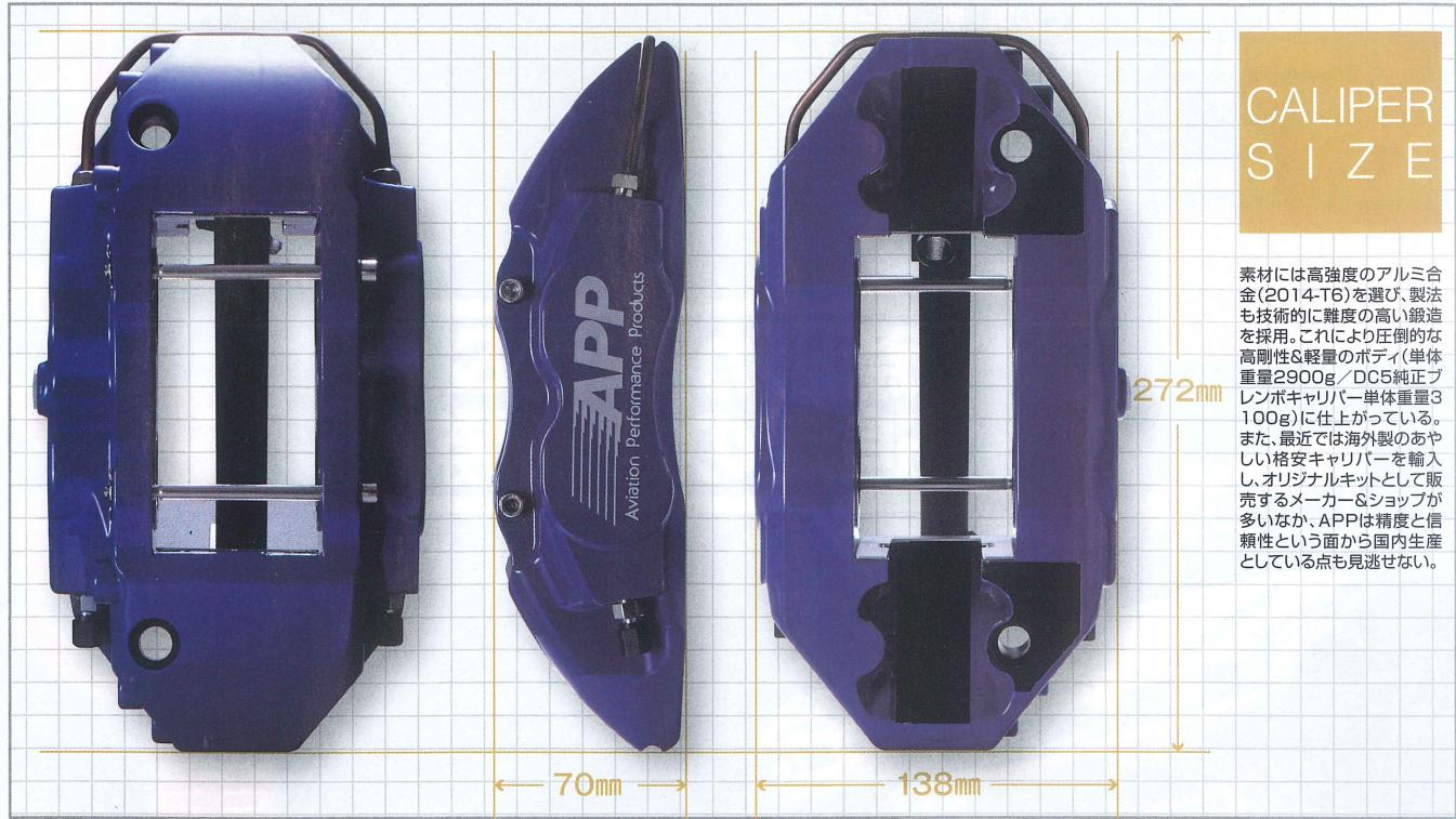
素材には高強度のアルミニウム(2014-T6)を選び、製法も技術的に難度の高い鋳造を採用。これにより圧倒的な高剛性&軽量のボディ(単体重量2900g/DC5純正ブレンボキャリパー単体重量3100g)に仕上がっている。また、最近では海外製のあやしい格安キャリパーを輸入し、オリジナルキットとして販売するメーカー&ショップが多いなか、APPは精度と信頼性という面から国内生産としている点も見逃せない。
