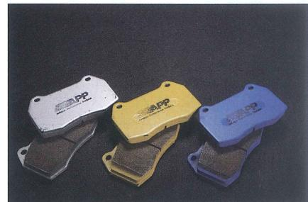
キット付属のブレーキパッドは3種のなかから自由に選ぶことが可能。ストリート向けのタイプSA(白/摩擦係数0.32~0.45μ/対応温度0~500°C)、ストリート~サーキット向けのタイプSR(青/摩擦係数0.38~0.62μ/対応温度0~800°C)、タイムアタック専用のタイプRA(黄/摩擦係数0.42~0.59μ/対応温度200~800°C)だ。
