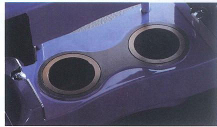
ピストン径は38mmの同径タイプ。ピストンエリアは45.34㎠となり、純正ブレンボ(45.47㎠)とほぼ同等の数値を保持している。これにより、速和感のないハーダルストロークと操作性を実現したのだ。もちろん、ストリートでの使い勝手を考慮し、各ピストンにはダストシールが装備される。
